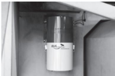
**Schritt 1:** Montieren Sie den Staubsauger seitlich der Eingangsstufen (ca. auf halber Höhe).
