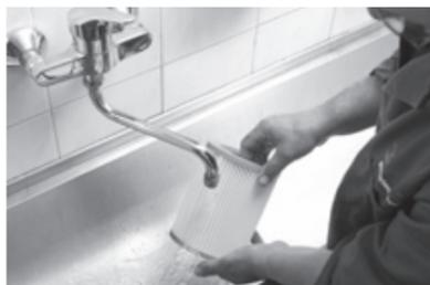
**Fase 6:** Per evitare il surriscaldamento del motore, è necessario controllare che i filtri siano sempre puliti. Rimuovere immediatamente eventuali tracce di sporco.
